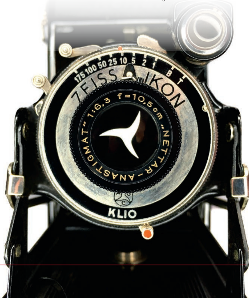
Geöffneter mechanischer Zentralverschluss einer Foto-Balgenkamera
