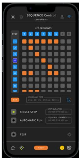
Schritten leuchten soll. Die Folge der einzelnen Schritte ergibt eine Sequenz. Diese kann maximal aus 16 Schritten bestehen und sowohl im Einzelschrittbetrieb als auch im Automatikbetrieb ablaufen.
