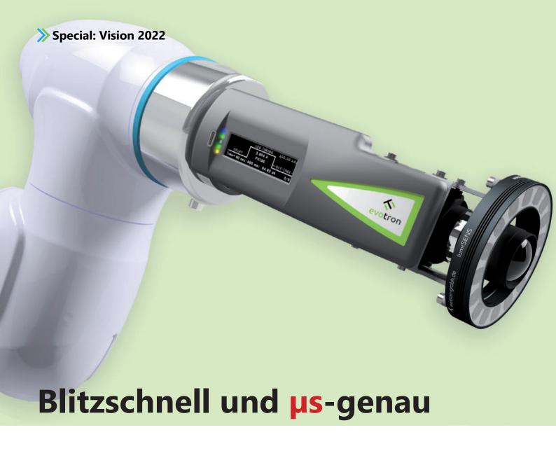
**BELEUCHTUNG** – Mit LumiSens von Evotron wird der Roboter zur sehr exakten und blitzschnellen Mess- oder Prüfmaschine. Das erhöht die Zuverlässigkeit von Prüfprozessen und macht Beleuchtungen automatisierungstauglich.
