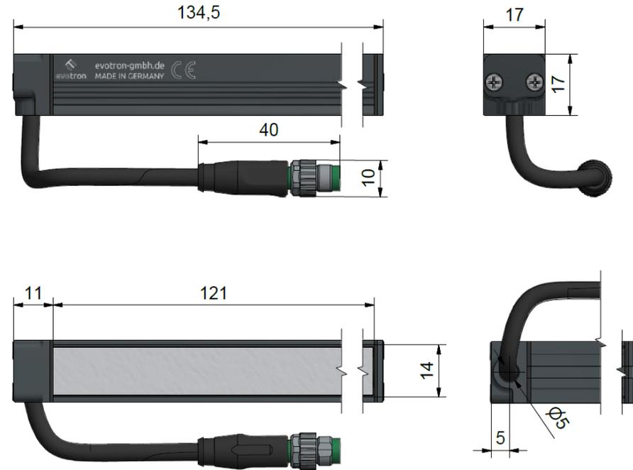
Kabellänge ohne Steckverbinder = 200 mm
