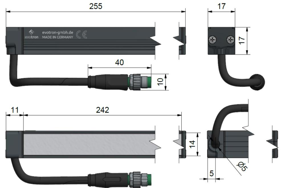
Kabellänge ohne Steckverbinder = 200 mm
