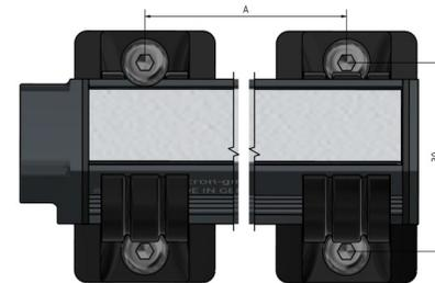
A =  $l_{\text{Leuchtfeld}} - 18\text{mm}$  4 x Schraube M4 (ISO 7380-2)
