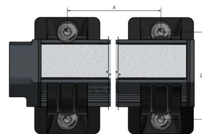
A =  $l_{\text{Leuchtfeld}} - 18\text{mm}$  4 x Schraube M4 (ISO 7380-2)
