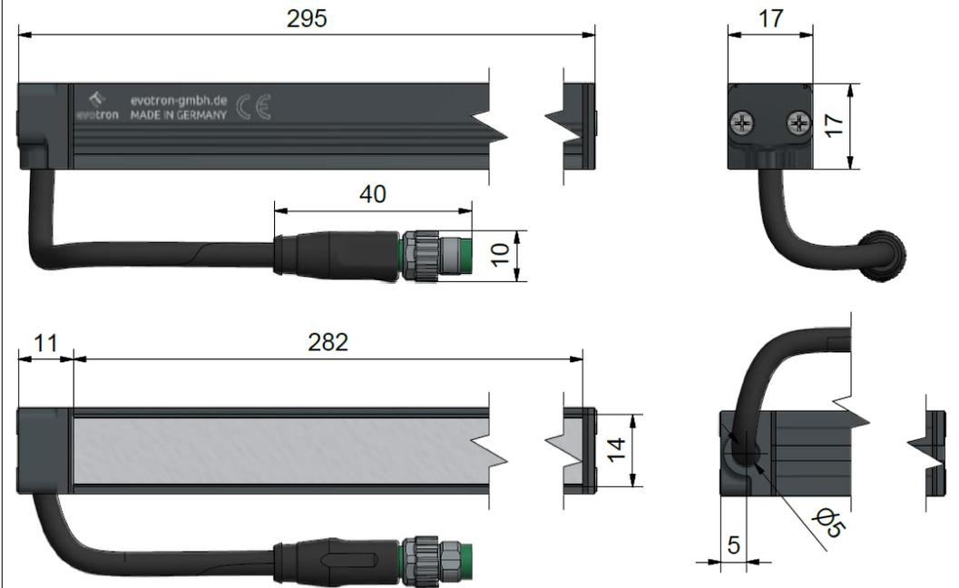
Kabellänge ohne Steckverbinder = 200 mm
