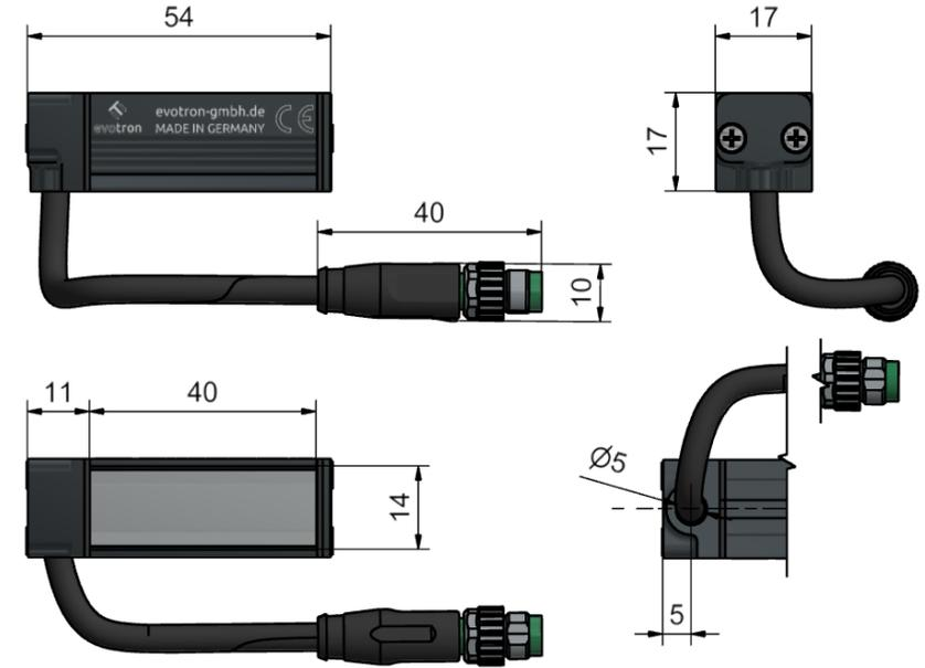
Kabellänge ohne Steckverbinder = 200 mm
